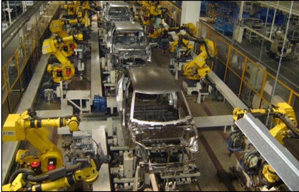
Εικόνα 1.6 Σύγχρονο εργοστάσιο παραγωγής αυτοκινήτων. Αντικατάσταση των εργατών από τα ρομπότ στη διαδικασία συναρμολόγησης των εξαρτημάτων
